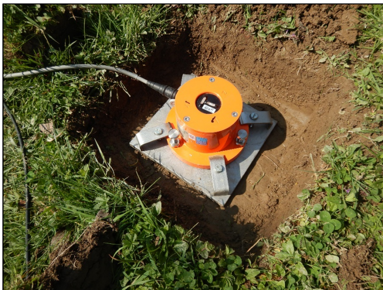
Abbildung 4: Messaufbau mit Seismometer
